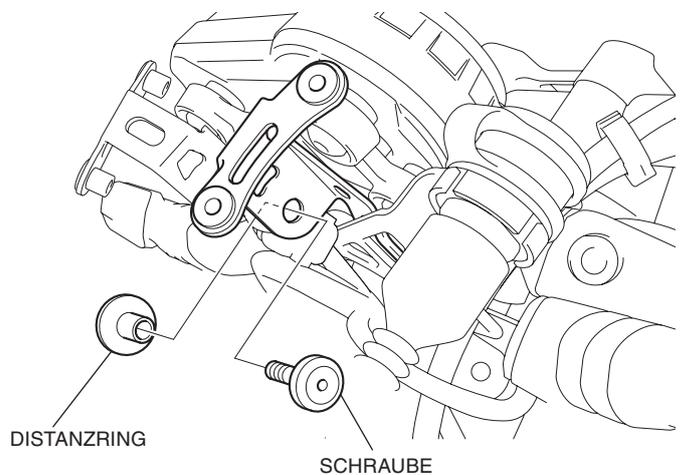
16. Montieren Sie die Distanzringe in der umgekehrten Ausbaureihenfolge an den Scheinwerfer.
