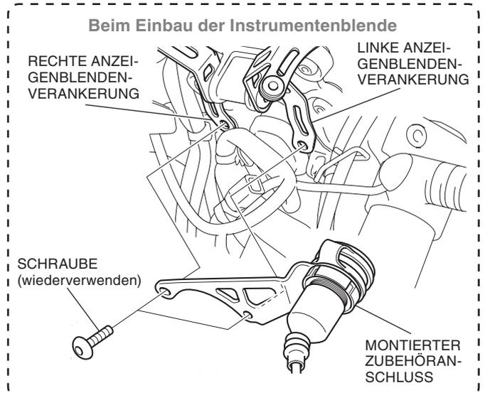
15. Entfernen Sie die Schraube und den Distanzring, wie in der Abbildung dargestellt.
