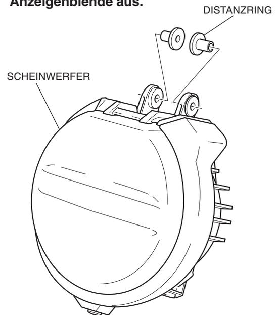
7. Montieren Sie die Schraube und den Distanzring, wie in der Abbildung dargestellt, ohne sie festzuziehen.
