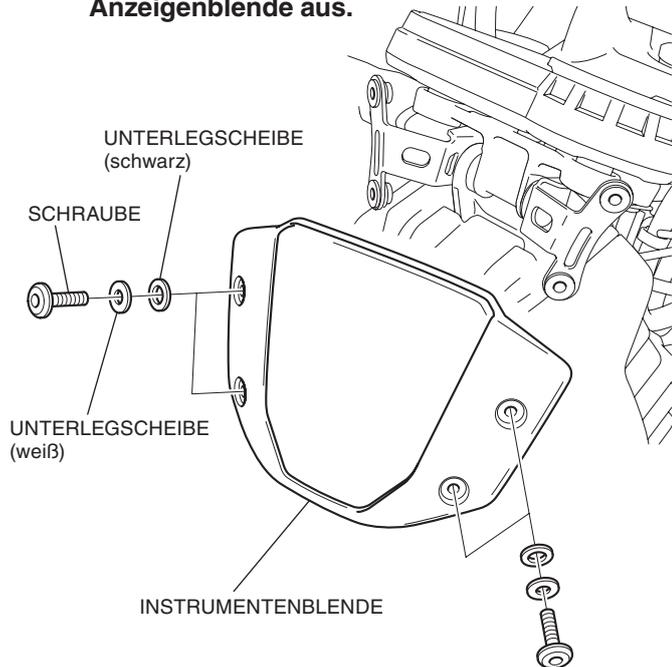
4. Entfernen Sie die Schraube, wie in der Abbildung dargestellt.
