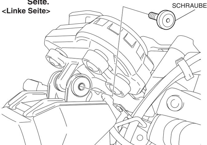
Beim Einbau der Instrumentenblende
