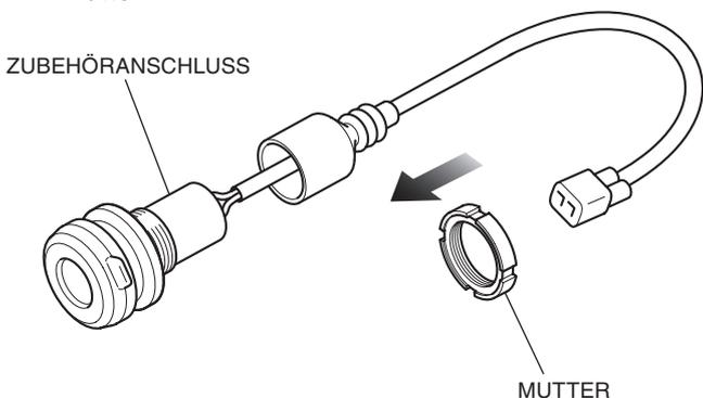
10. Montieren Sie den Zubehöranschluss wie in der Abbildung dargestellt.
